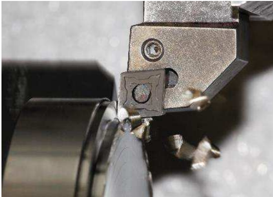
Bild1: NMR-Spanbrecher in Aktion: Der NMR-Spanbrecher eignet sich zum Drehen bei mittelschweren und schweren Anwendungen.
