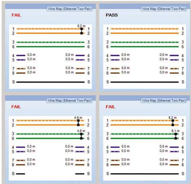
◀ Bild 4: Im Feld eingebaute Messstellen zeigen bis zu zwei Kurzschlüsse
