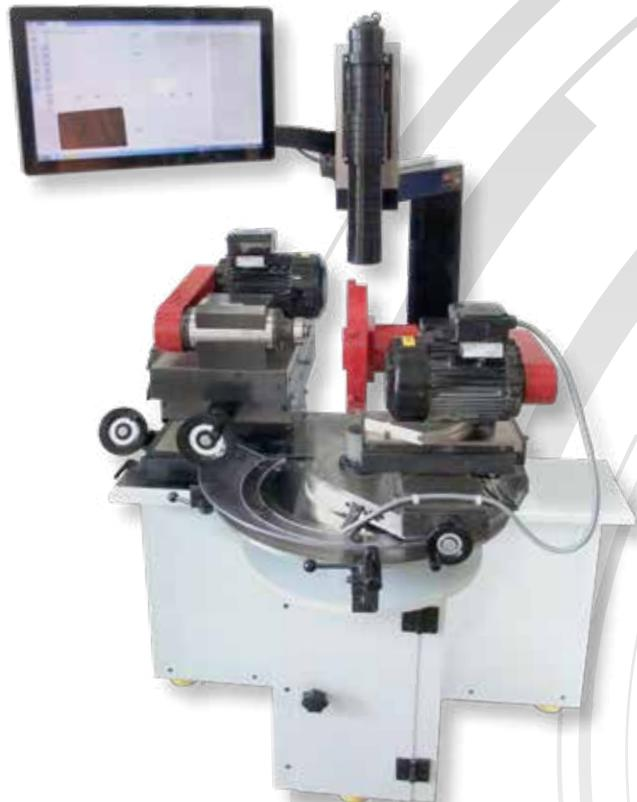
**Telezentrisches Zoomsystem** in einer Abrichtmaschine GAP 4 von Cleveland
