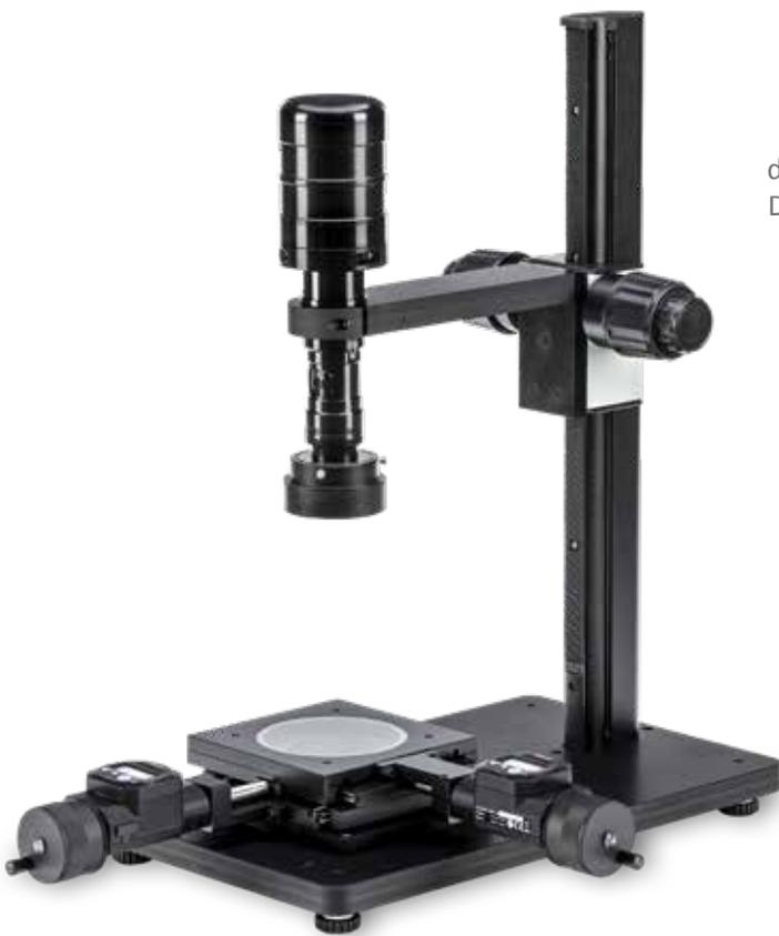
Die Anforderungen an Optik, Beleuchtung, Stativ und Kreuzmesstisch, ergeben sich aus der Prüf- oder Messaufgabe. Wir müssen hierbei genau darauf achten, daß wir eine Vergrößerung einsetzen, die sich an der geforderten Messgenauigkeit orientiert.
