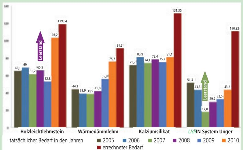
Quelle: Grafik 25 Entwicklung des Heizwärmebedarfs kWh/m² der Dämmvarianten von 2005 bis 2010 im Vergleich zu dem errechneten Jahresbedarf (Deutsches Fachwerkzentrum Quedlinburg)
