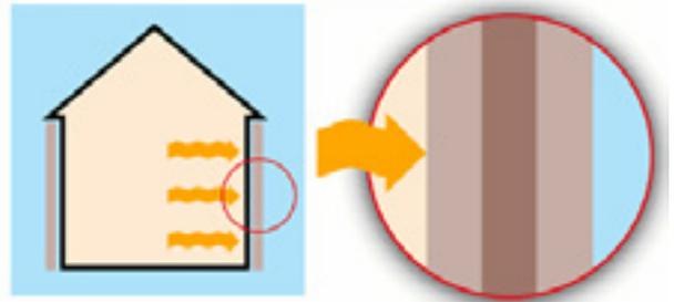
An ungedämmten Außenwänden kühlt die Raumluft ab, fällt zu Boden und strömt zur Raummitte, wo sie sich erwärmt und wieder aufsteigt.
