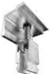
Die Befestigung der PV-Module auf den TR-Längschiene ist mittels der Klick-Klemme mit integrierten Erdungspins möglich. Die systemübergreifende Universalklemme ist zwischen 30 und 46 mm höhenverstellbar und kann bequem eingeklickt werden.
